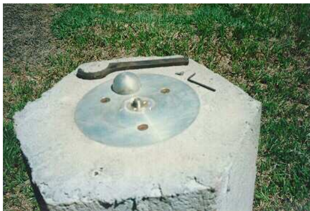
Figura 22 - Dispositivo de Centragem forçada padrão UFPR aberto.
