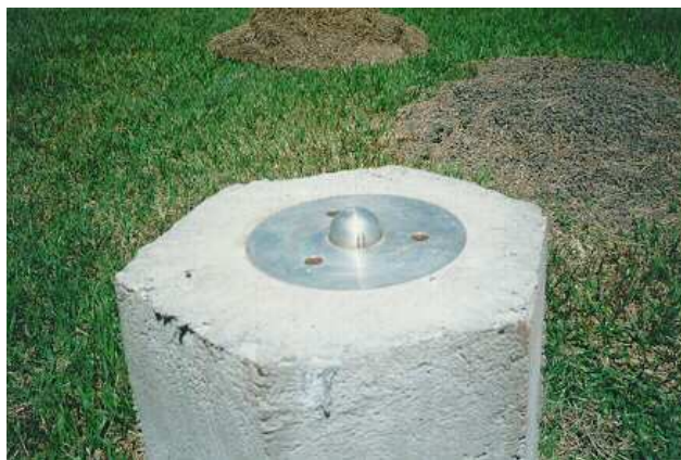
Figura 23 - Dispositivo de Centragem forçada padrão UFPR fechado.
