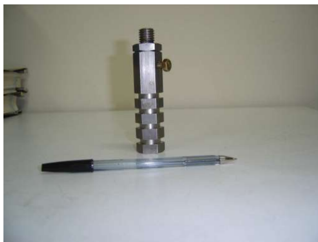
Figura 26 - Pino de centragem forçada padrão IBGE.
