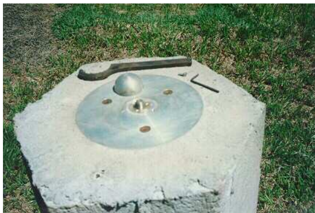
Figura 22 - Dispositivo de Centragem forçada padrão UFPR aberto.
