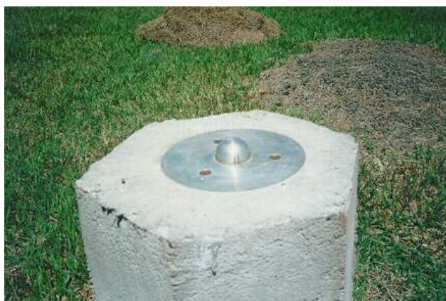
Figura 23 - Dispositivo de Centragem forçada padrão UFPR fechado.
